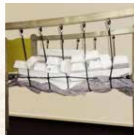
Nach DIN EN 1176-1 wird rechnerisch ein Sicherheitsfaktor von 1,35 gefordert, im praktischen Nachweis der Faktor 2.
